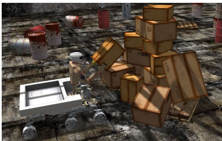
Рис. 6. Захват коробки роботом-кентавром
