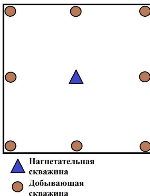
Рис. 1. Элемент девятиточечной системы расстановки скважин
