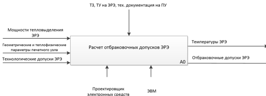
Рис. 3. Контекстная диаграмма IDEF0 системы расчета отбраковочных допусков ЭРЭ
