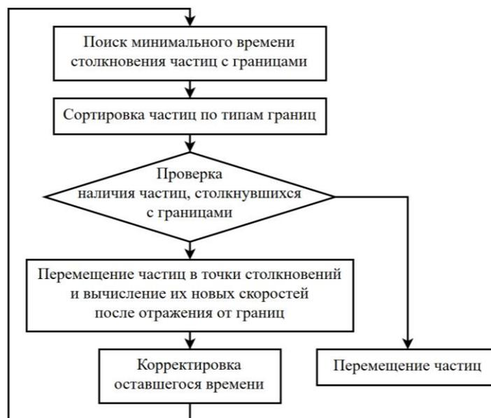
**Рис. 4. Схема расчета траектории движения частиц с учетом их возможного взаимодействия с подвижными границами**
