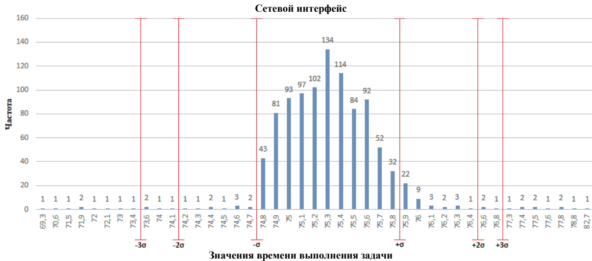
Рис. 2. Гистограмма частот времени выполнения задачи при сетевом интерфейсе
