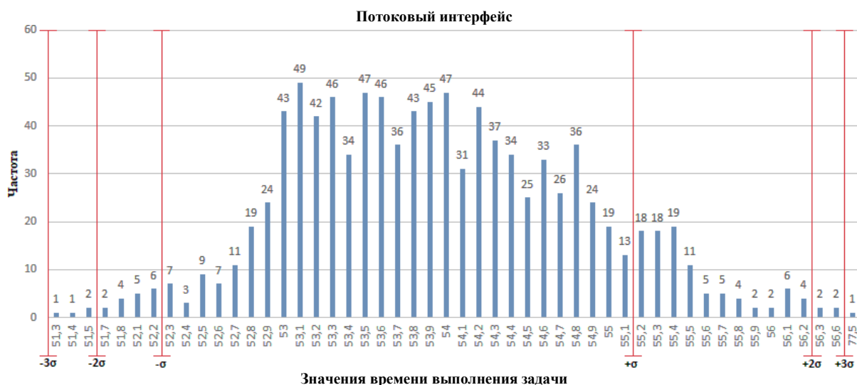
Рис. 1. Гистограмма частот времени выполнения задачи при потоковом интерфейсе
