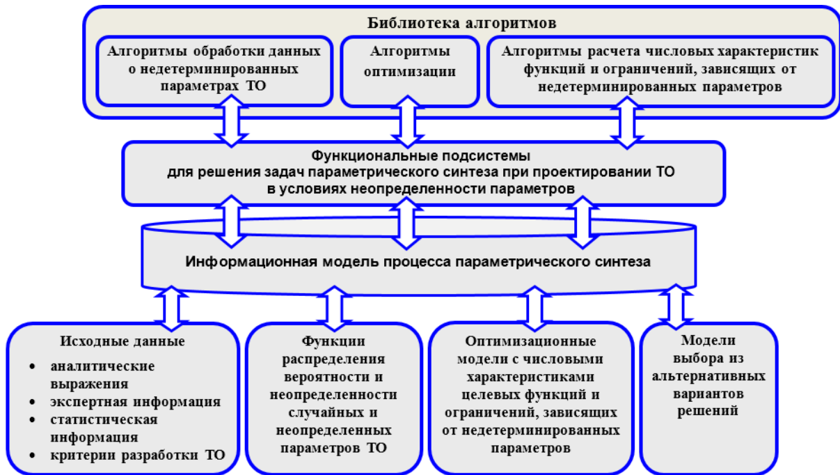
Рис. 1. Схема информационного обмена в инструментальной программной среде для решения задач параметрического синтеза при предварительном проектировании ТО в условиях неопределенности параметров
