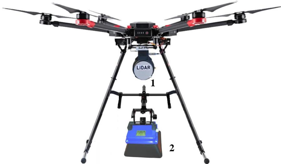
Рис. 7. Платформа Matrice 600 для проведения обследования
