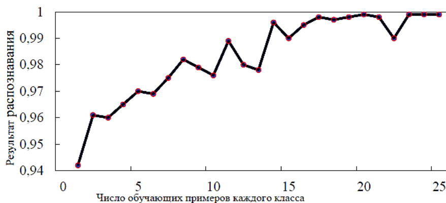
Рис. 6. Результаты распознавания векторных сигналов газоданалитической мультисенсорной линейки с помощью ИНС при последовательном увеличении обучающей выборки по предложенному алгоритму Примечание: составлено авторами.
