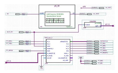
**Рис. 4.** Блок-схема передачи данных с ПЛИС на ЭВМ по интерфейсу USB 3.0 *Примечание:* составлено авторами на основании данных, полученных в исследовании.
