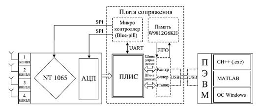
Рис. 2. Структурная схема комплекса
