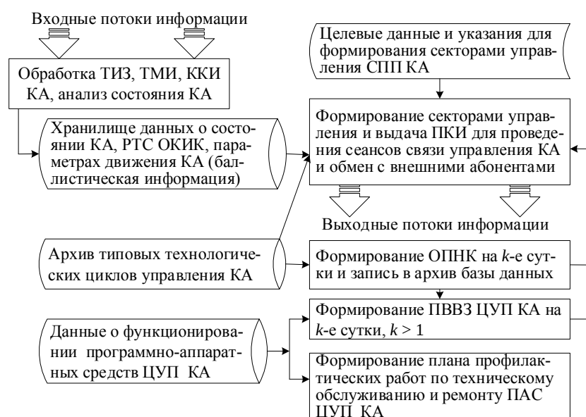
Рис. 1. Схема технологии функционирования центра управления полетами космических аппаратов
