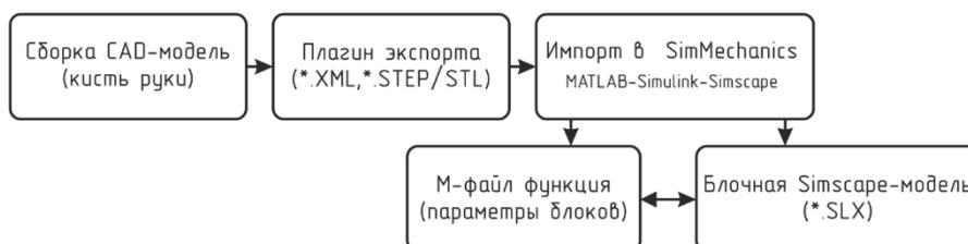
Рис. 4. Пользовательский импорт CAD-модели в систему MATLAB/Simulink
