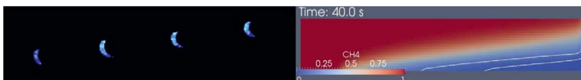
Рис. 8. Последовательные положения фронта пламени стратифицированной метановоздушной смеси и моделирование процесса распространения пламени
