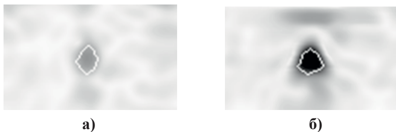
Рис. 4. Радиолокационные изображения пластикового диска при разном энергетическом потенциале а) p , дБ = 136; б) p , дБ = 146
