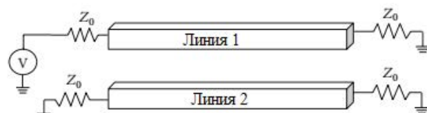
Рис. 1. Параллельные линии проводников на печатной плате
