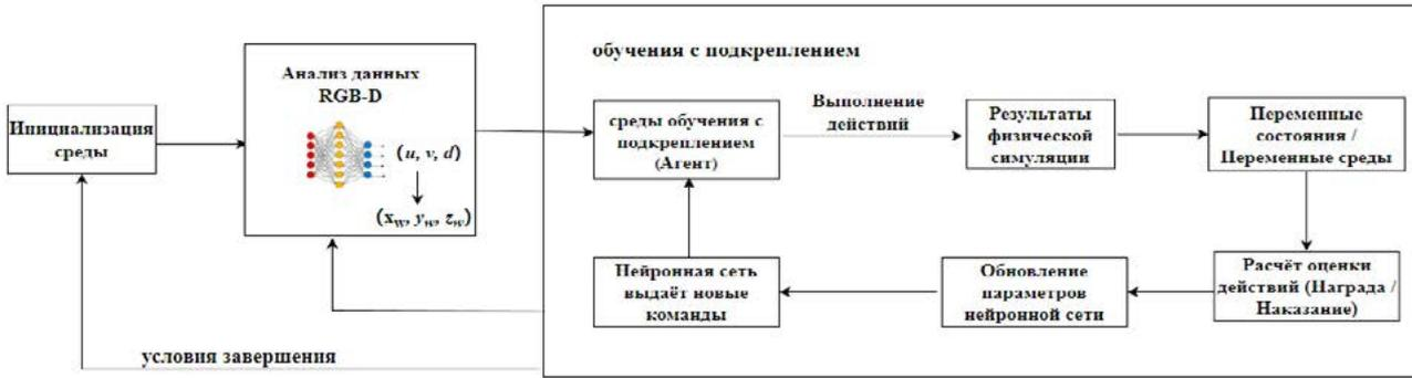
Рис. 3. Схема работы системы управления манипулятора
