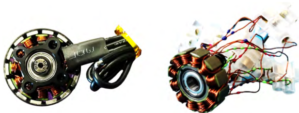
Рис. 1. BLDC-двигатель Brother Hobby Avenger 2806,5 1300kV до перемотки (слева) и после перемотки с убранным ротором (справа)
