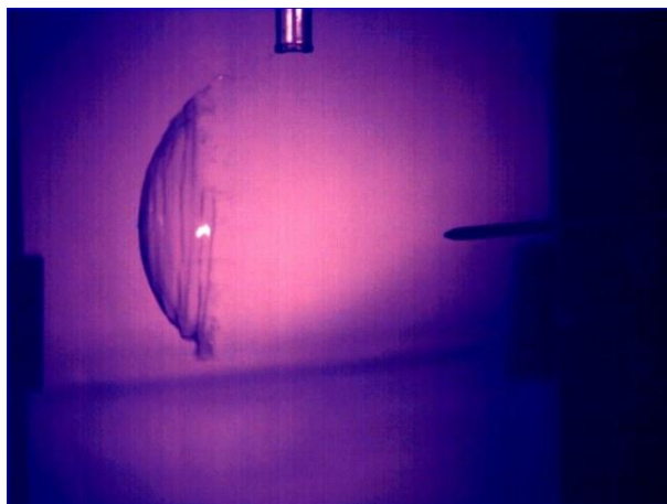
Рис. 5. Кадр распада мыльного пузыря с волнообразными возмущениями на его поверхности Примечание: составлено авторами на основании данных, полученных в исследовании.
