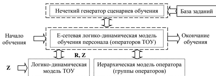
Рис. 1. Структурная схема системы обучения операторов ТОО
