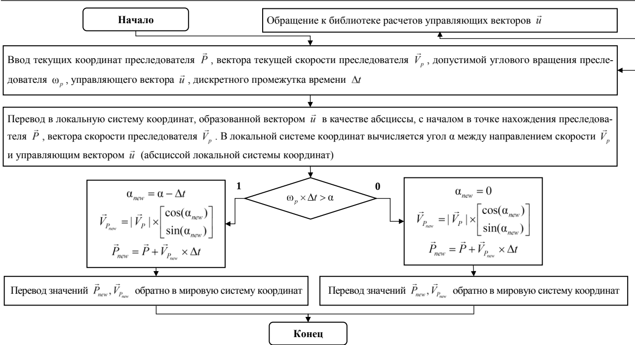
Рис. 1. Блок-схема расчета фазовых координат преследователя на следующем шаге Примечание: составлено автором на основании данных, полученных в исследовании.
