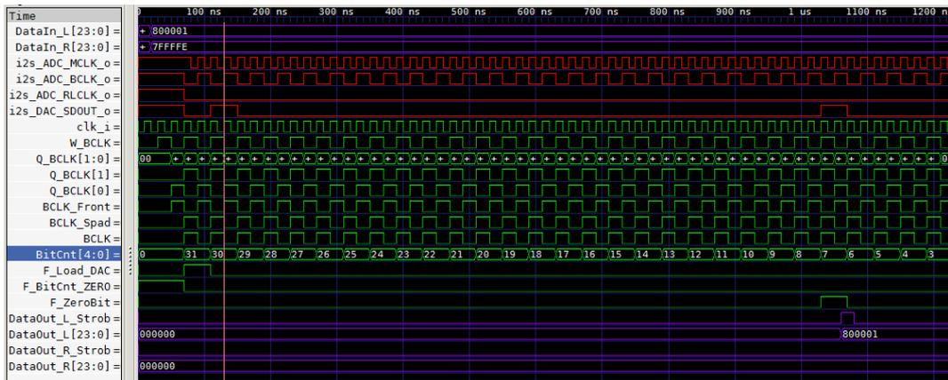
Рис. 8. Временная диаграмма работы блока I<sup>2</sup>S
