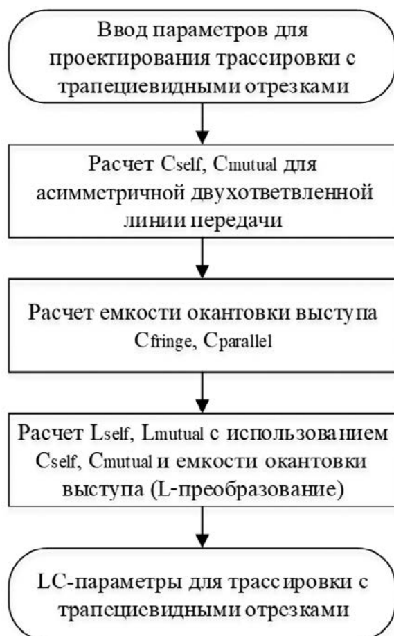
Рис. 6. Блок-схема разработанной методики трассировки с трапецевидными отрезками, основанной на методе сегментации Примечание: составлено авторами.
