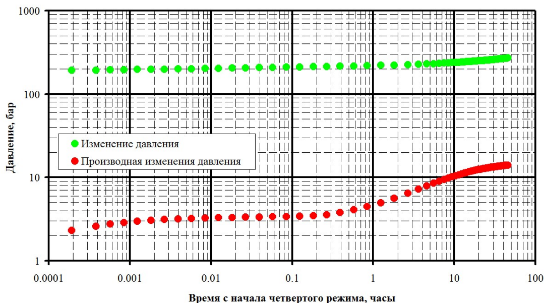
Рис. 1. Пример обработки ГДИ горизонтальной скважины с переменным дебитом методом наилучшего совмещения по эмпирической модели
